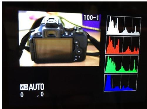
A gauche on trouve les tons noirs, à droite les tons blancs et entre les deux il y a les nuances de gris. L'axe vertical montre la quantité de pixels pour chaque valeur de luminosité.
