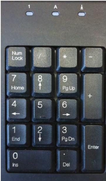
Avant d'utiliser le pavé numérique, il est indispensable de vérifier que les chiffres sont verrouillés. Le principe du verrouillage des chiffres est le même que celui des majuscules c'est pour cela qu'il existe une touche nommée « Verr Num » (ou en anglais Num Lock).
