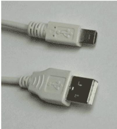
L'embout du bas (le plus grand) est à brancher sur l'ordinateur et celui du haut, sur l'appareil photo numérique. Sur l'appareil photo, la prise se trouve derrière un cache où peut être marqué OUT / DIGITAL / USB...
