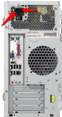
**Ventilateur** : il évacue l'air chaud et favorise l'aspiration d'air frais à travers les fanons d'aération.
